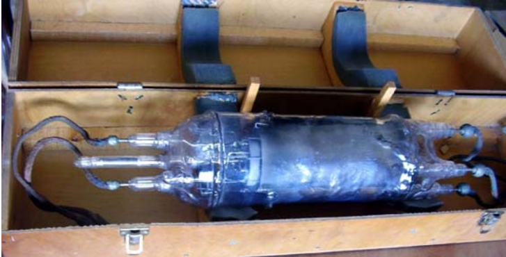
Fig. 20 - A TYSS-2000 silica valve.
